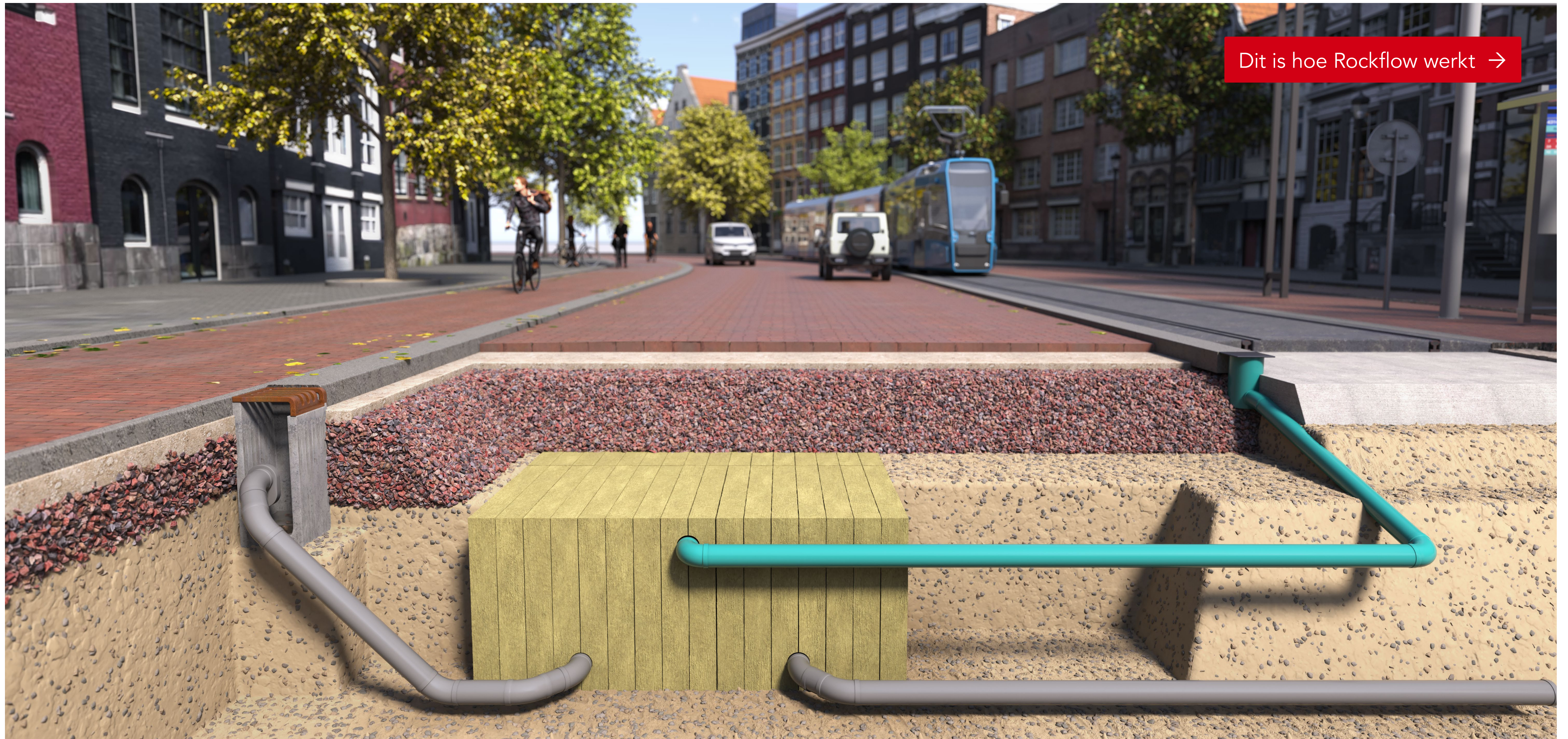
Figuur 6: Schematische weergave van een Rockflow systeem onder een weg, met wateraanvoer vanuit een straatkolk (grijs) en een ontluchtingskolk (groen).
