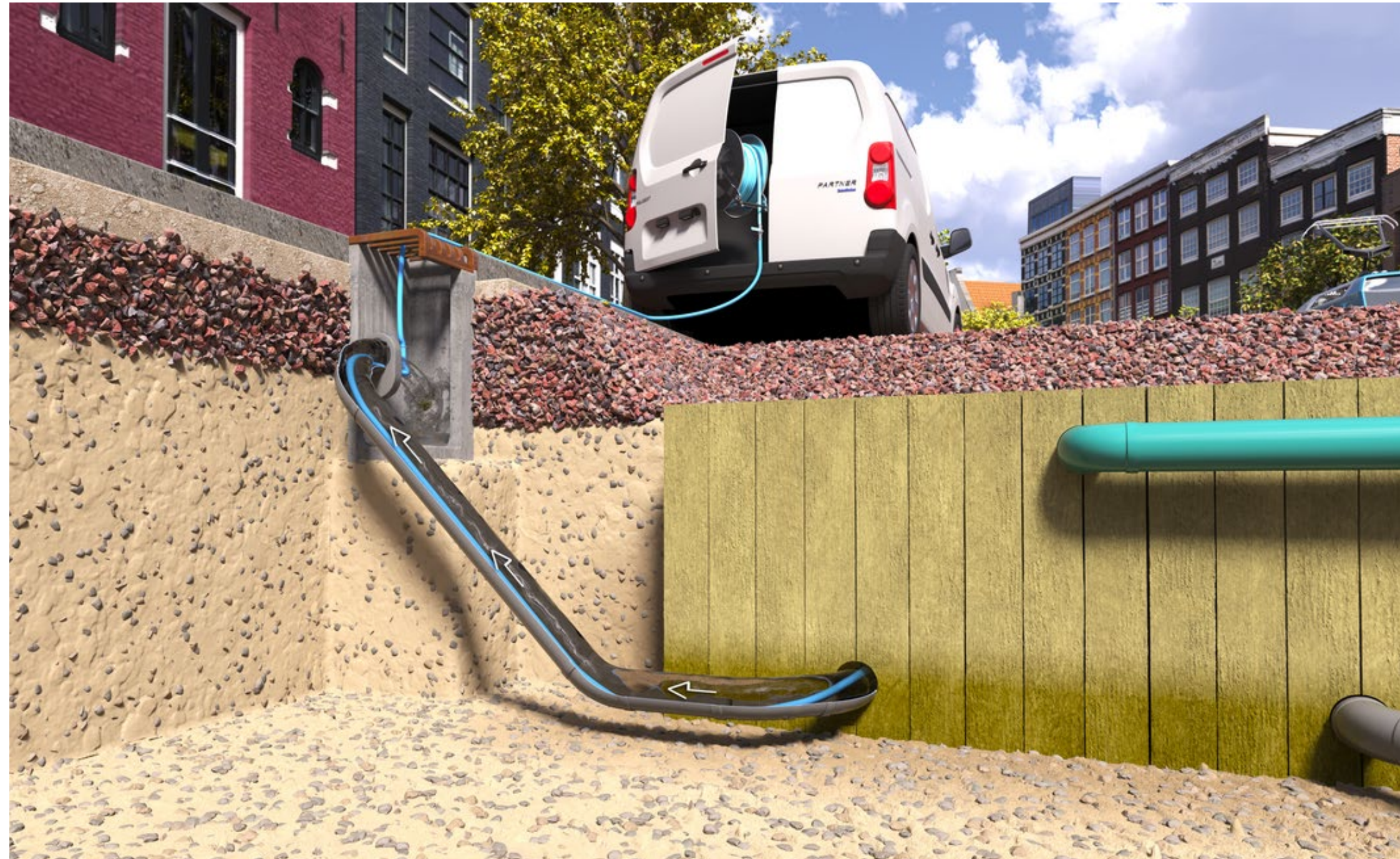
Figuur 7: Inspectie en onderhoud van de waterkanalen via bv. een inspectieput. Hierbij wordt de vervuiling uit de kanalen teruggespoeld naar de put.
