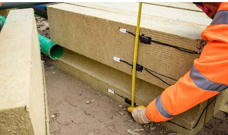
Een Rockflowsysteem met vochtmeters.
